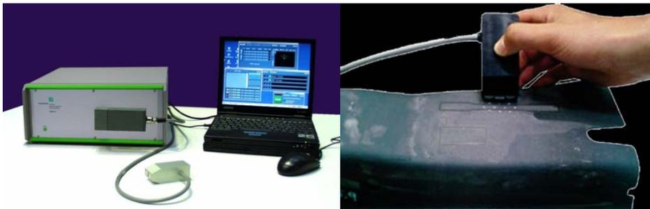
3MA-Gerät und 3MA-Prüfung (Bildrechte: Fraunhofer IZFP)
